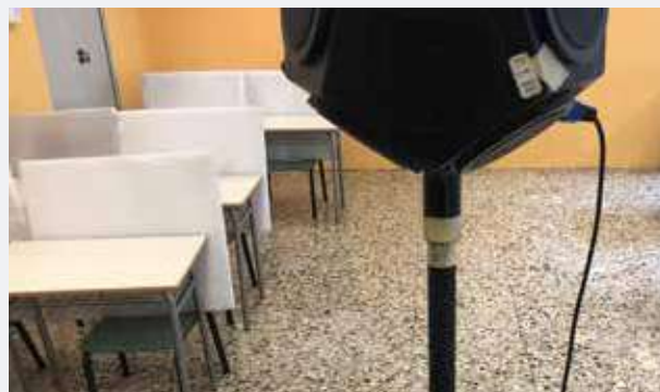
Figura 3.34 - Posizionamento dei pannelli fonoassorbenti in fibra 100% poliestere per la simulazione dell'occupazione dell'aula.
