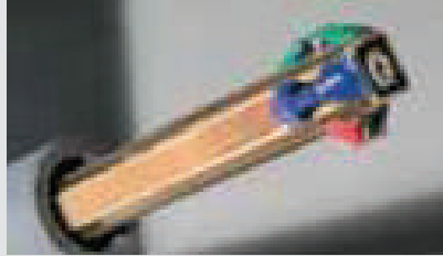
fig. 8 Titan by Microflowm®, l'ultima sonda di nuova generazione per la misurazione simultanea delle quattro componenti del campo acustico: la pressione e le tre componenti della velocità delle particelle d'aria. Titan by Microflowm®, the latest state of the art sound probe that simultaneously measures the four components of the acoustic field: pressure and the three air particle velocity components.
